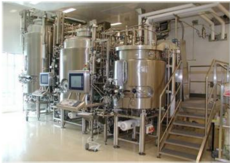
Exemple de fermenteurs utilisés pour la production de vaccins
